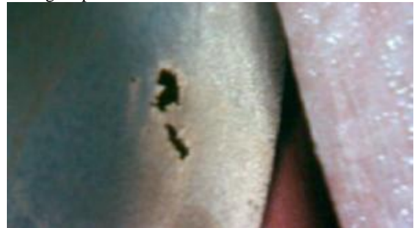
3. Rotor após jateamento (notar furo).
