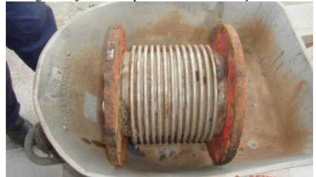
2. Notar desgastes (corrosão severa).
