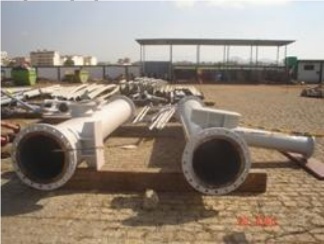
8. Spool's após pintura externa – tinta comercial.
