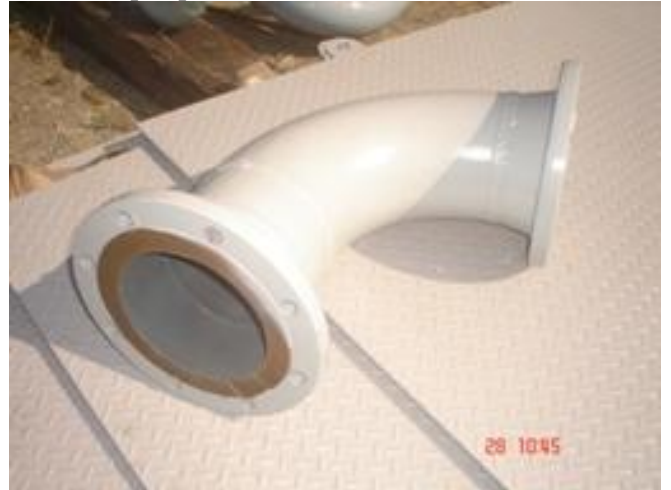
9. Curva após pintura externa - tinta comercial..
