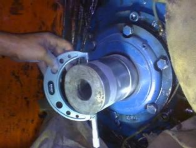
6. Conferência das tolerâncias com micrômetro.
