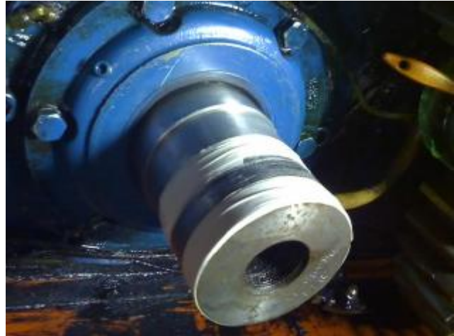
1. Eixo do TS-1004 antes do serviço, notar desgaste.
