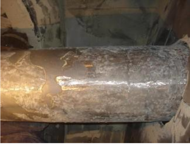
6. Aplicação de Belzona® 1812 na superfície do eixo.
