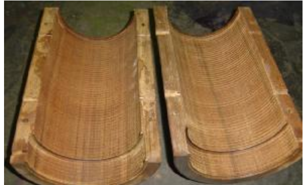
2. Aplicação de Belzona ® 1111 no molde.
