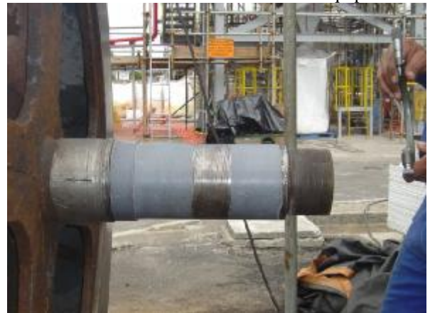
11. Dimensões dentro das tolerâncias do equipamento.
