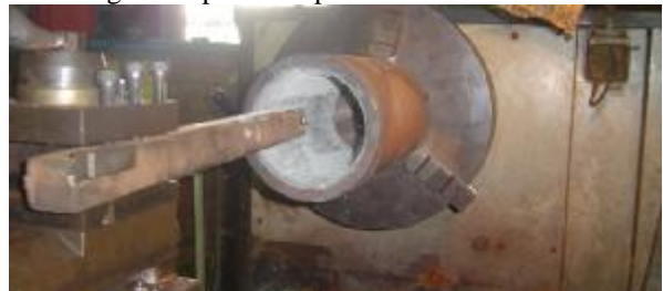
4. Aplicação do agente desmoldante (Belzona ® 9411).
