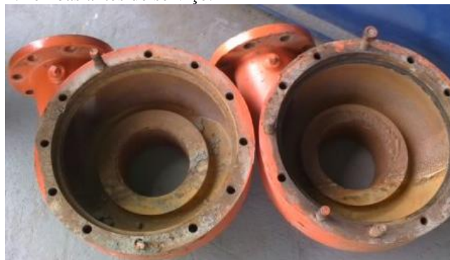
2. Tampa extremamente desgastada.
