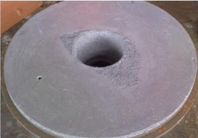
9. Rotor após recuperação e revestimento com Belzona®1321X.
