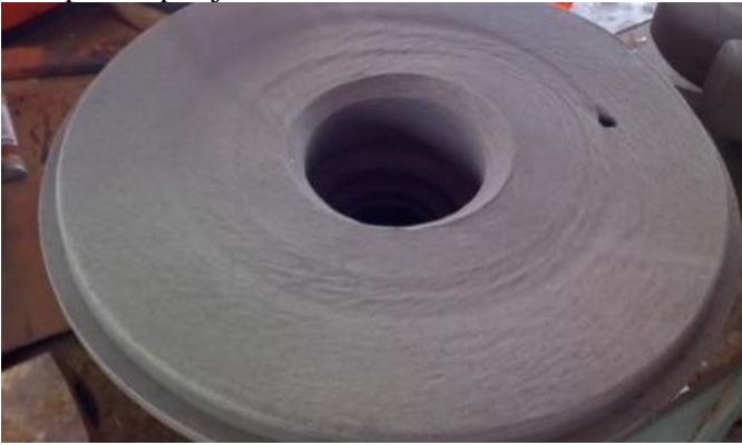
7. Recuperação de desgastes em espelho por moldagem com Belzona®1812.
