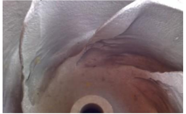
8. Voluta após recuperação e revestimento com Belzona®1812.
