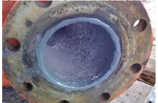
10. Extremidade da descarga revestida com Belzona®1321 X para não interferir no processo de vedação da peça
