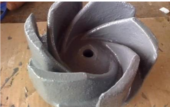
9. Rotor após recuperação e revestimento com Belzona®1321X.
