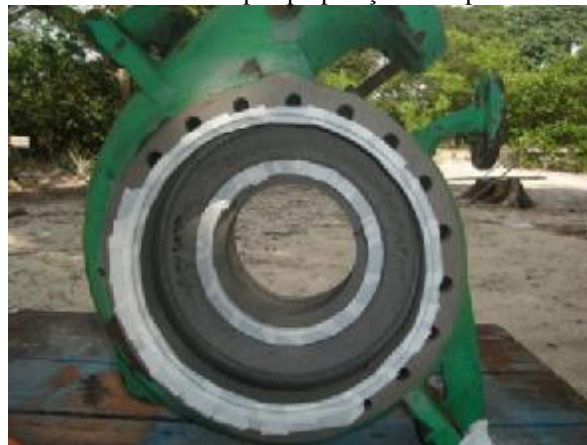
2. Notar desgastes na superfície interna.
