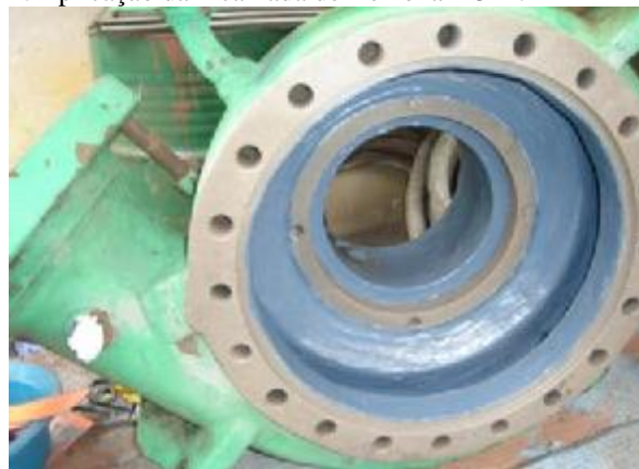
4. Aplicação da 1ª camada de Belzona ® 1321.
