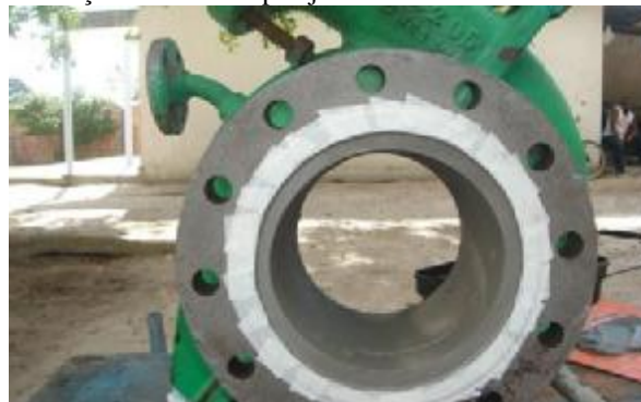
4. Aplicação da 1ª camada de Belzona ® 1321.
