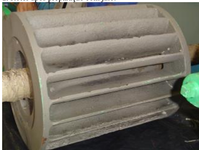
2. Detalhe dos desgastes no rotor.
