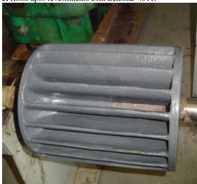
3. Rotor após revestimento com Belzona® 4311.
