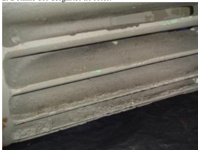
3. Rotor após revestimento com Belzona® 4311.
