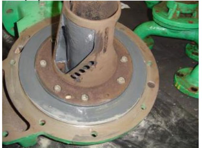
7. Tampa após revestimento com Belzona® 4311.
