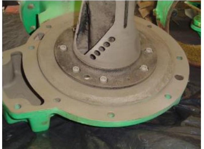
7. Tampa após revestimento com Belzona® 4311.
