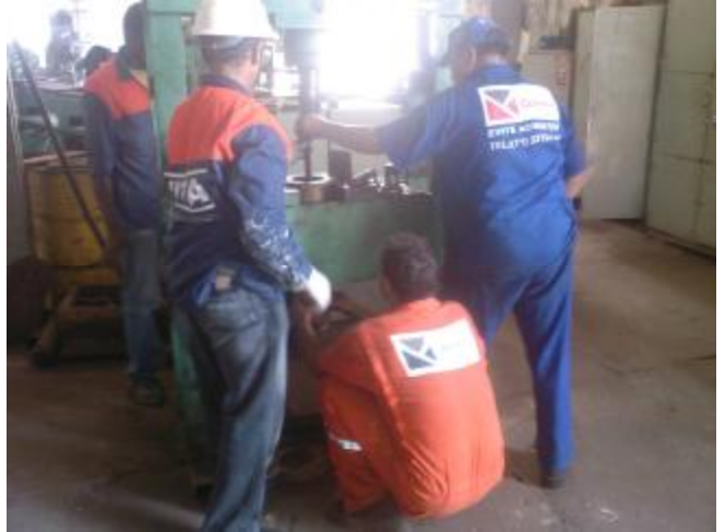
7. Remoção do molde com auxílio da prensa.
