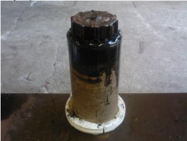
6. Aplicação de Belzona® 2131 na bucha.
