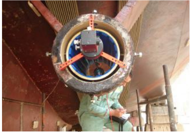
9. Aplicação de Belzona® 5811 por injeção.
